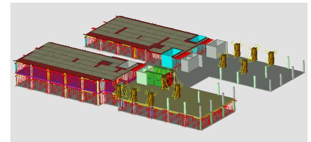
Im Modul Design werden **Schalungspläne vollautomatisch in 2D und 3D erstellt**.
